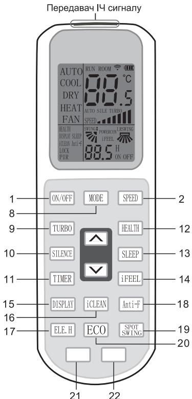
сну кондиціонер кожну годину збільшує (при режимі охолодження) або зменшує (при режимі обігріву) задану температуру на 1 °C. Через 2 години температура приймає нове значення, яке підтримується постійно протягом наступних 5 годин. Після цього кондиціонер відключачеться.
